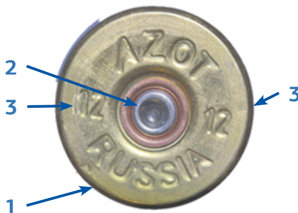
Рис. 1. Увеличенное изображение дна гильзы стреляной из охотничьего гладкоствольного оружия отечественного производства:
